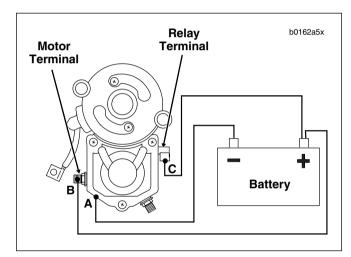
Figure 1-6. Test 2: Hold-In Test
